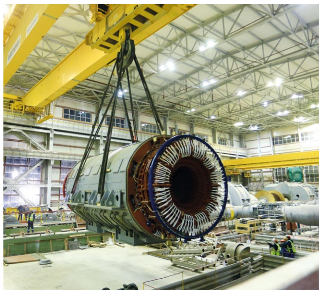
Статор генератора помещён на самоходный модуль с электронным управлением – специальную тележку, предназначенную для перемещения крупногабаритных грузов
