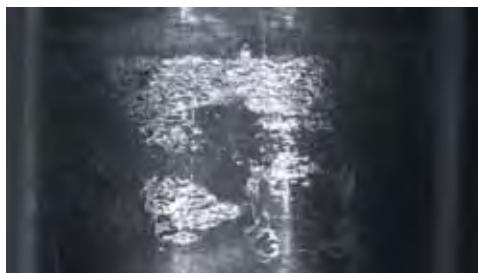
Рис. 10. Потертость модели №8 на уровне первой ДР
