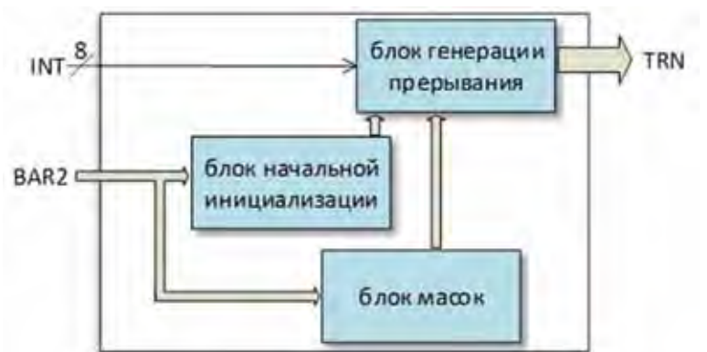
Рис. 5. Структурная схема модуля генерации MSI-X прерываний
