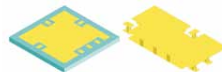
Рис. 3. Размещение контактных площадок, монтажной площадки (слева) и соединение металлизированного основания и монтажной площадки корпуса (справа)
