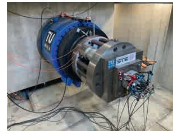
Рис. 2. Испытание вантового пучка СТС на выносливость
